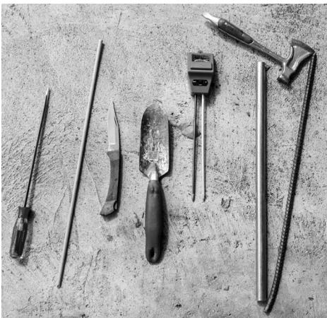
Todos estos instrumentos se pueden usar para medir la humedad del suelo: un destornillador largo, una barra de madera, un cuchillo, una llana manual, un medidor de humedad y un tubo de paredes delgadas, un martillo y barra de acero.
