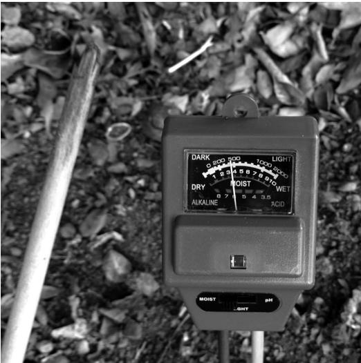
A pesar de que el suelo se ve seco, tanto el medidor de humedad como la barra de madera indican que hay abundante humedad a 4" de profundidad.
