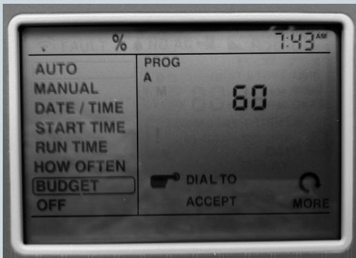
La característica de regulación del presupuesto en el controlador de riego automático es una manera rápida de responder a condiciones cambiantes. ¿Un monzón a mediados del verano? Reduzca todo el riego en un 60 %. ¿Tiempo gris de junio en julio? Reduzca todo el riego en un 40 %. La regulación del presupuesto permite un rápido control de todas las válvulas de riego.
