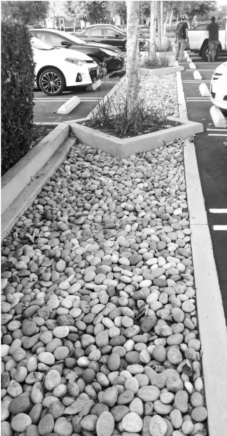
La roca de río tiene numerosos usos. La piedra puede ayudar a activar la infiltración, volverse una superficie transitable y proporcionar elementos estéticos fuertes. Cal Poly Pomona.
